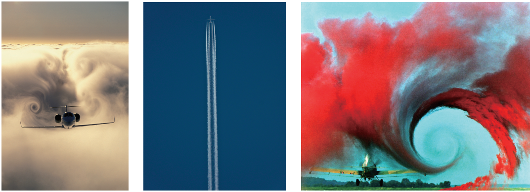
(a) Turbulences de sillage derrière un Learjet 60 dans un nuage [2] (b) Matérialisation des turbulences de sillage sous forme de traînées de condensation [3] (c) Turbulences de sillageensemencées de fumées colorées lors de tests effectués par la NASA [4]
