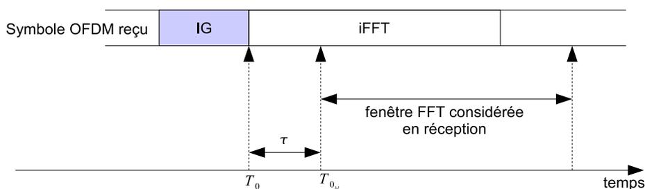
FIG. 2.2 – Définition de l'erreur de phase horloge.
