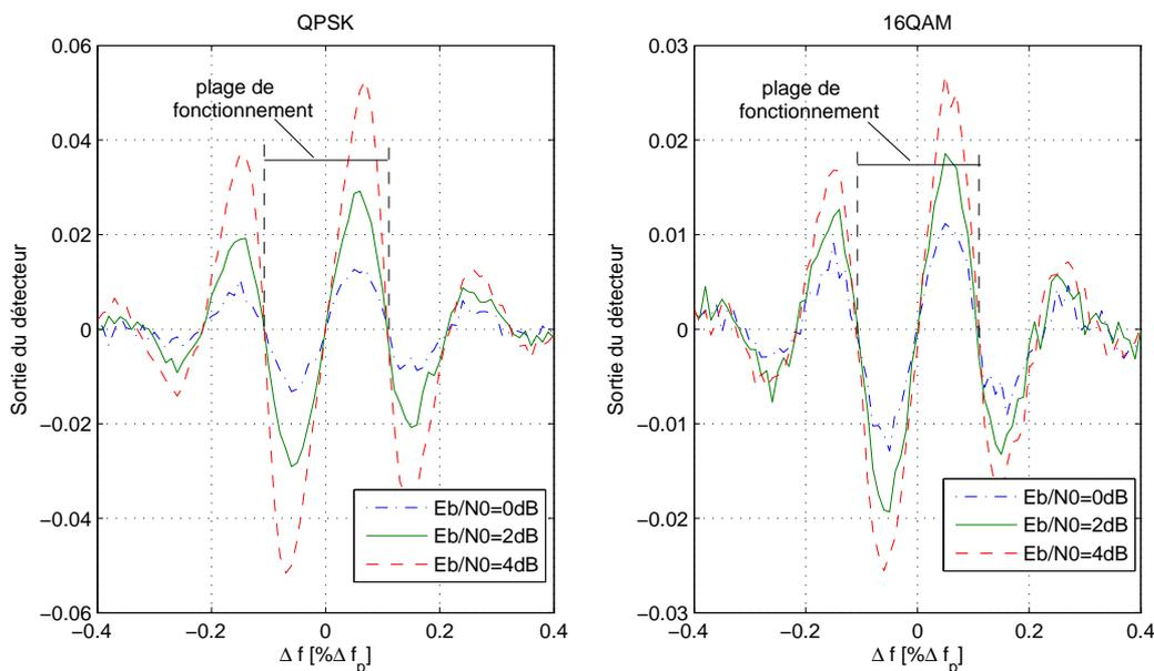
FIG. 3.3 – Caractéristique de la boucle de fréquence porteuse.
