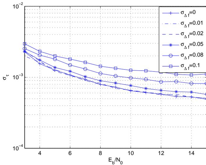
FIG. 3.19 – Impact de l’erreur résiduelle de fréquence porteuse sur la boucle de phase horloge, modulation 16QAM.
