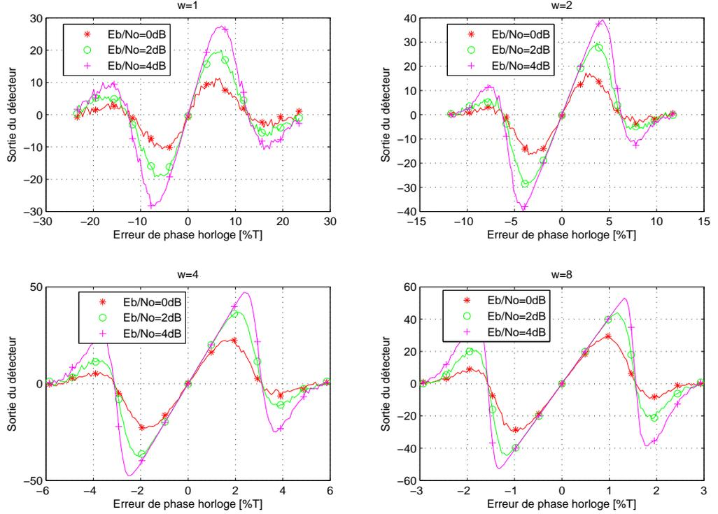
FIG. 3.12 – Caractéristique du détecteur de phase horloge, modulation 16QAM.
