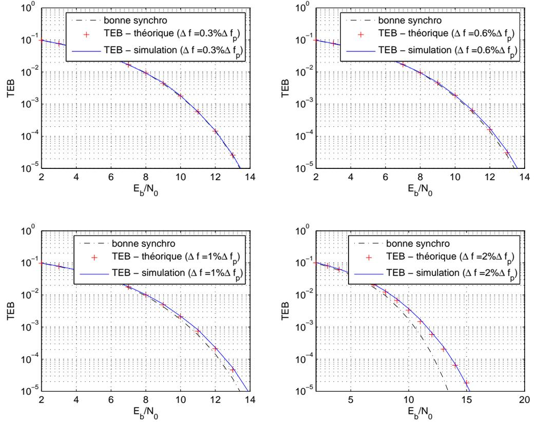
FIG. 2.7 – TEB théoriques et simulés, modulation 16QAM.
