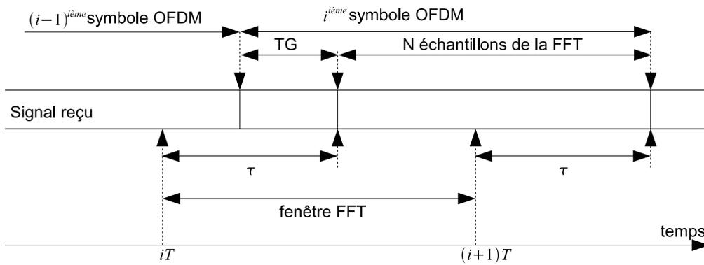
FIG. A.4 – Placement de la fenêtre FFT, cas 3.
