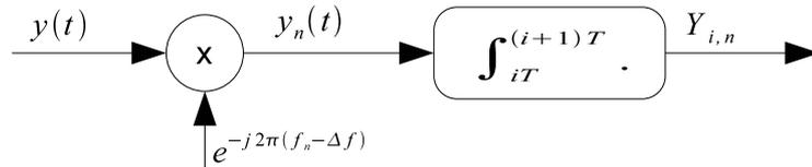
FIG. B.1 – Principe du récepteur OFDM en présence de l'erreur de fréquence porteuse  $\Delta f$ .
