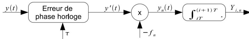
FIG. A.1 – Principe du récepteur OFDM en présence de l'erreur de phase horloge.
