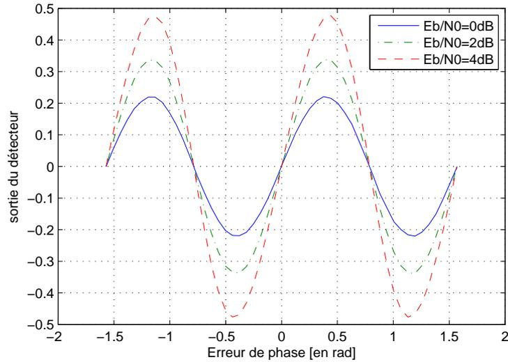
FIG. 4.2 – Caractéristique du détecteur de phase porteuse, modulation QPSK.
