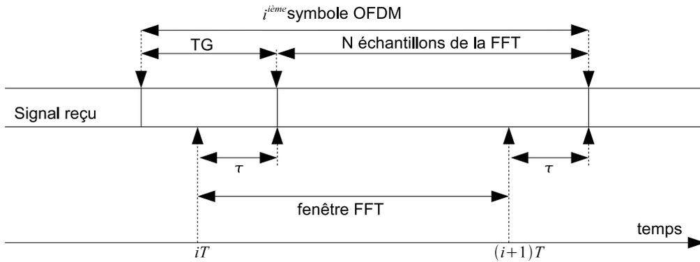
FIG. A.3 – Placement de la fenêtre FFT, cas 2.
