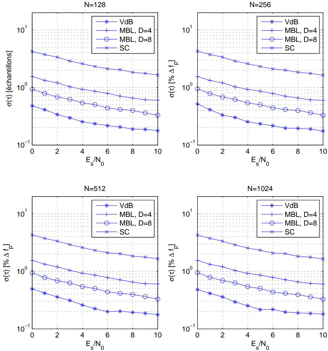
FIG. 3.26 – Performances des estimateurs de phase horloge à efficacité spectrale équivalente,  $\beta = 6.10^{-5}$ .
