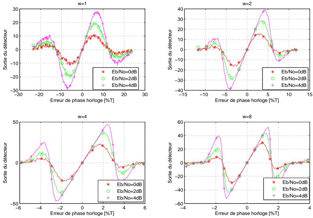
FIG. 3.11 – Caractéristique du détecteur de phase horloge, modulation QPSK.
