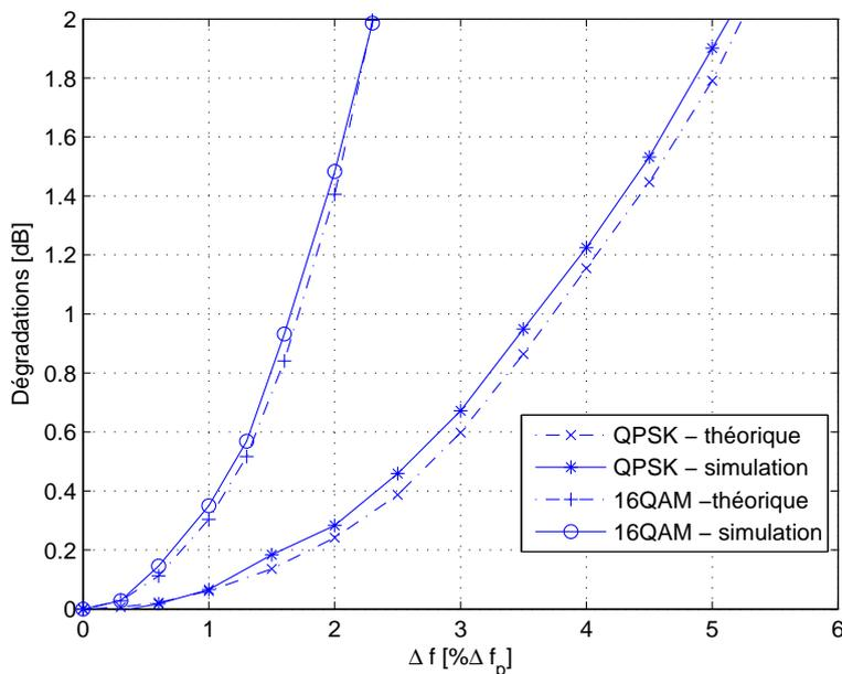
FIG. 2.8 – Dégradations du système à  $TEB=10^{-4}$ .
