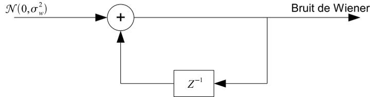
FIG. 1.6 – Principe de génération d'un bruit de phase de Wiener.
