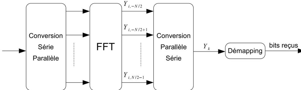
FIG. 1.12 – Schéma de principe d'un démodulateur OFDM numérique.
