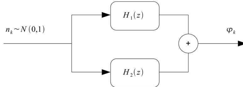
FIG. 1.3 – Modèle du bruit de phase, norme DVB-S2.
