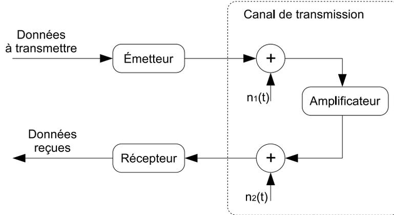
FIG. 1.1 – Principe d'une transmission par satellite.
