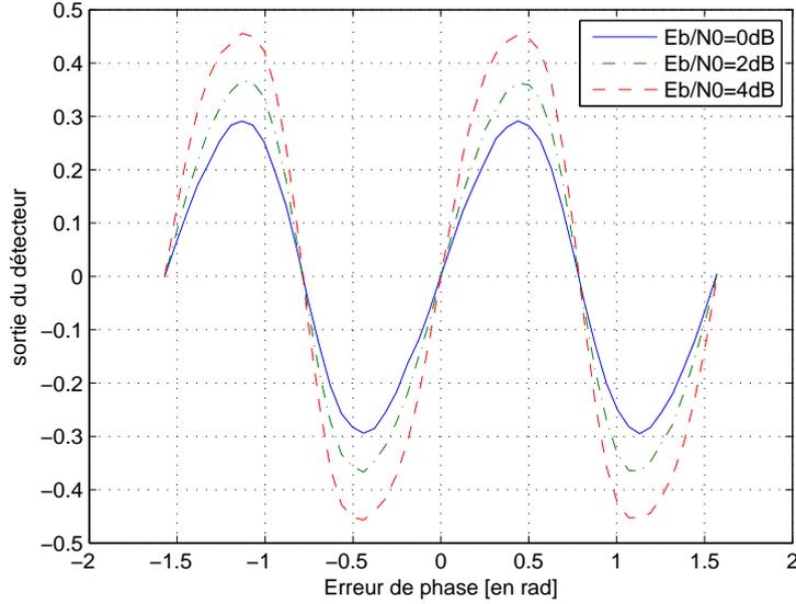
FIG. 4.3 – Caractéristique du détecteur de phase porteuse, modulation 16QAM.
