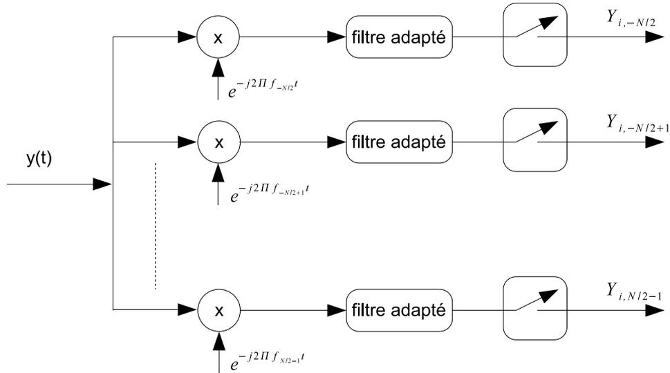
FIG. 1.9 – Schéma de principe d'un démodulateur OFDM.
