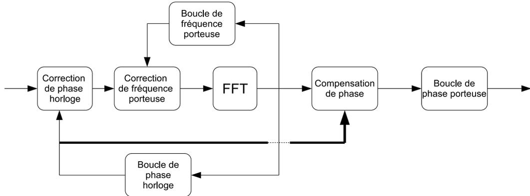
FIG. 4.4 – Compensation de phase porteuse due à la correction de phase horloge.
