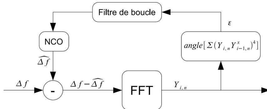
FIG. C.1 – Schéma de la boucle de fréquence porteuse.
