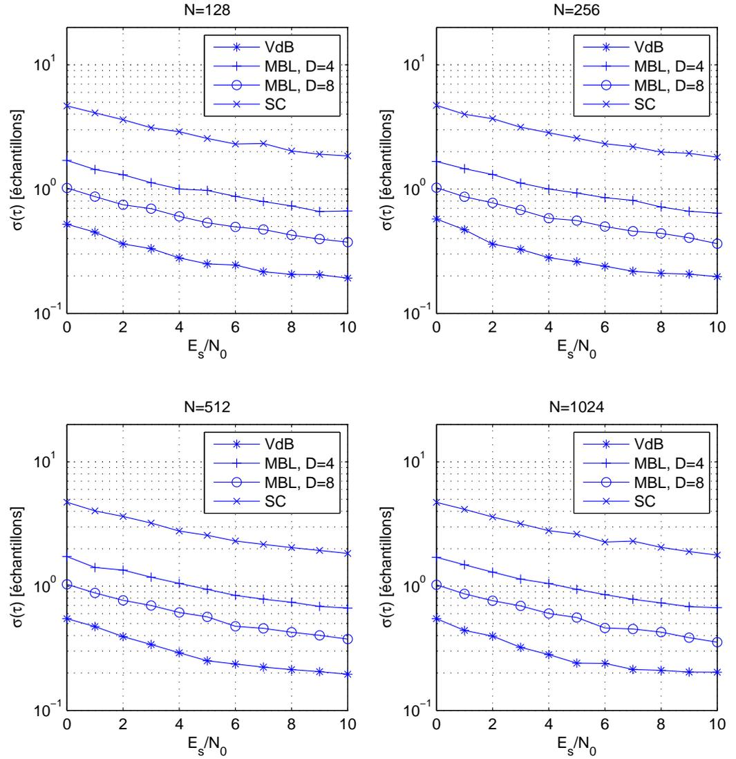
FIG. 3.25 – Performances des estimateurs de phase horloge à efficacité spectrale équivalente,  $\beta = 1,2 \cdot 10^{-4}$ .
