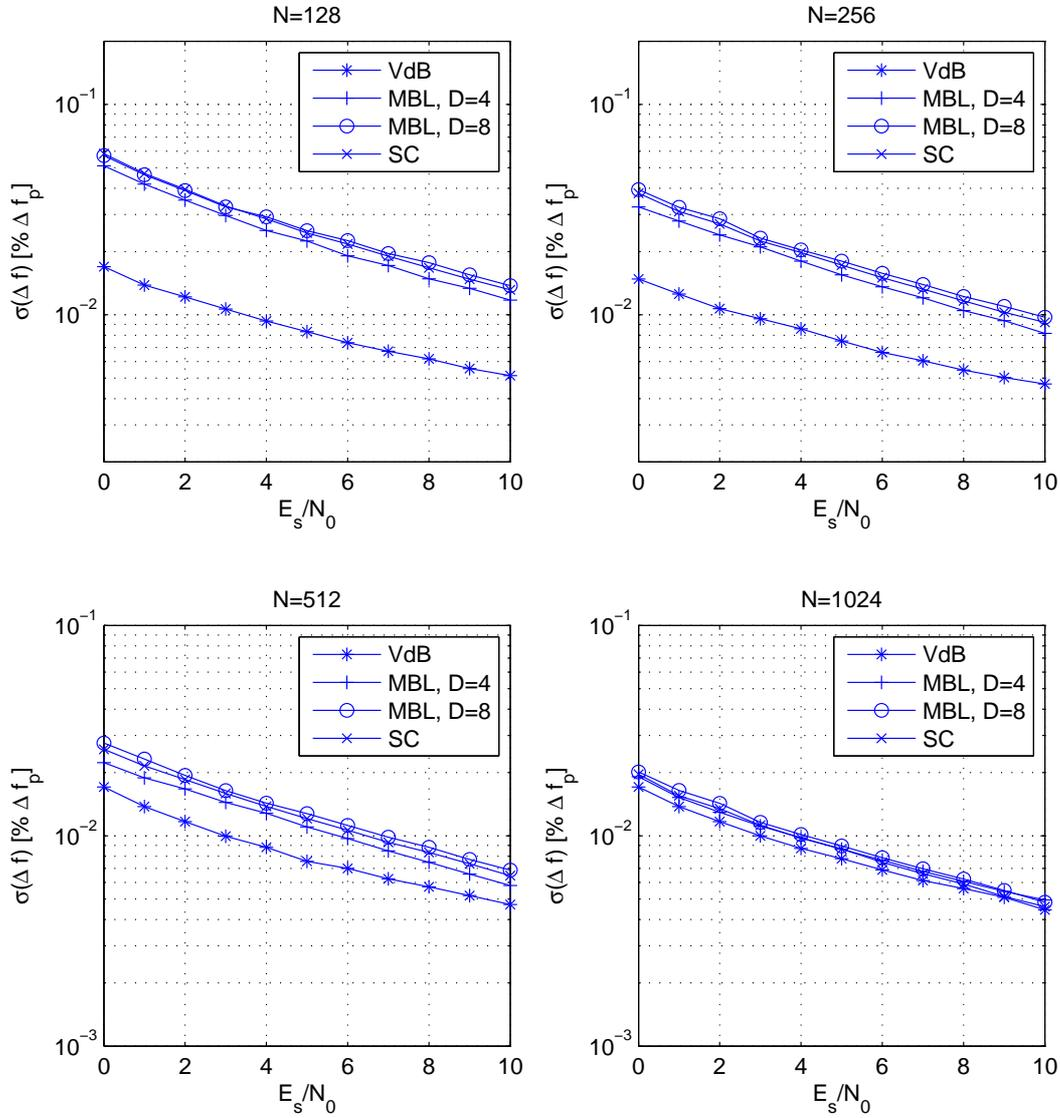
FIG. 3.28 – Performances des estimateurs de fréquence porteuse à efficacité spectrale équivalente,  $\beta = 6.10^{-5}$ .
