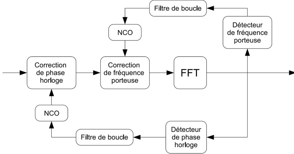
FIG. 3.1 – Schéma synoptique de l'étape de synchronisation fine de fréquence porteuse et de phase horloge.
