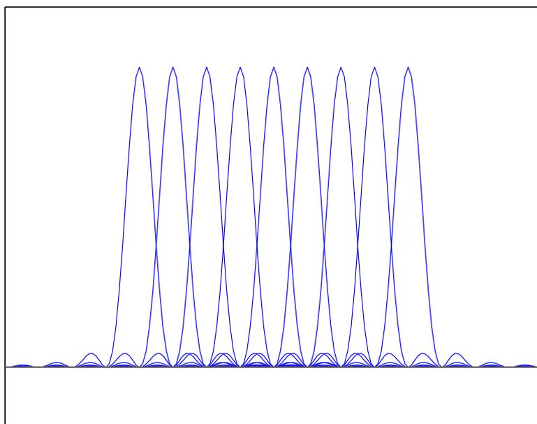
FIG. 1.10 – Spectre du signal en sortie du modulateur OFDM, décomposé sur chaque porteuse.
