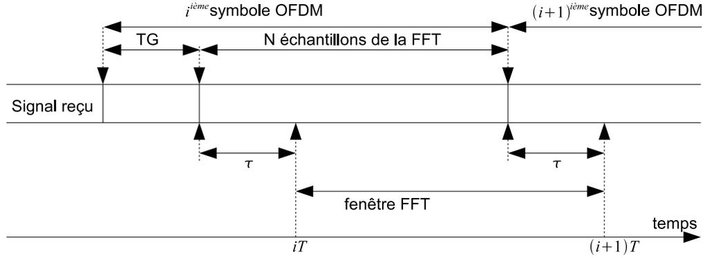
FIG. A.2 – Placement de la fenêtre FFT, cas 1.
