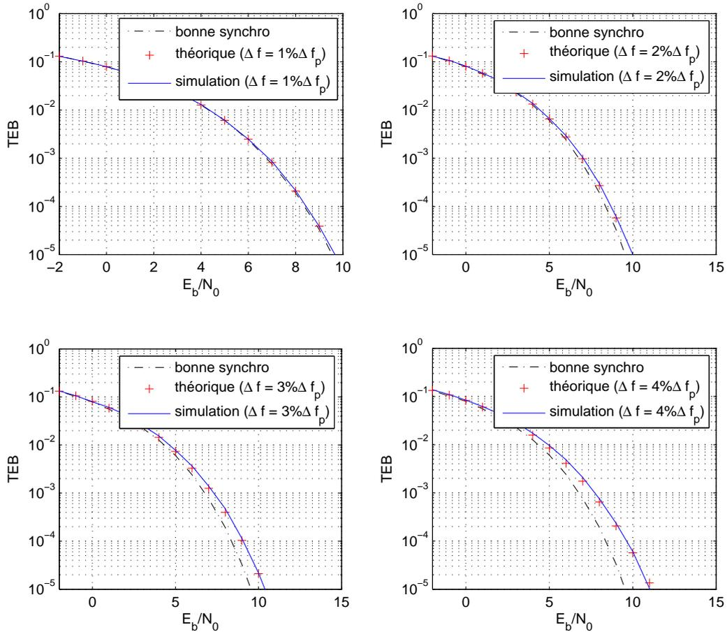
FIG. 2.6 – TEB théoriques et simulés, modulation QPSK.
