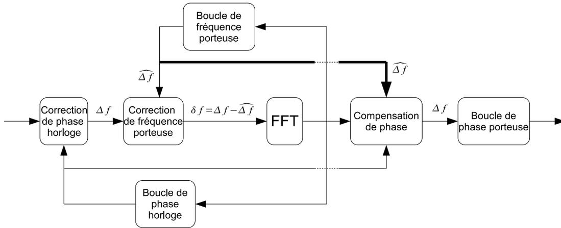
FIG. 4.7 – Compensation de phase porteuse due à la correction de fréquence porteuse.
