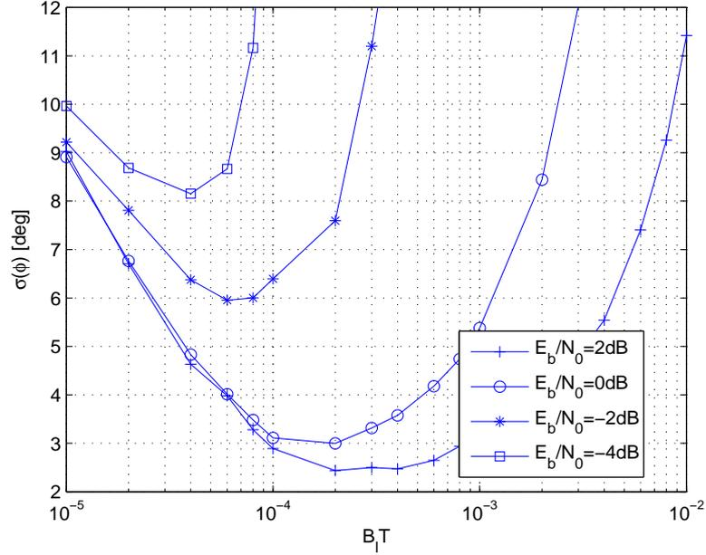
FIG. 4.14 – Performances de la boucle de phase porteuse en présence du bruit de phase du DVB-SH, modulation QPSK.
