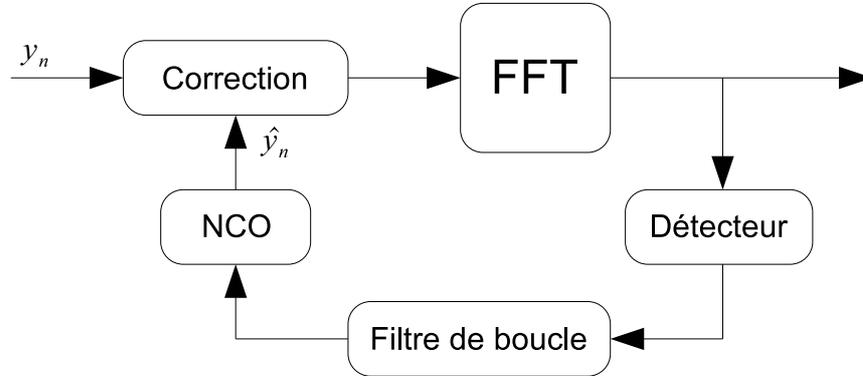
FIG. 2.9 – Principe d’une boucle de synchronisation dans un système OFDM.
