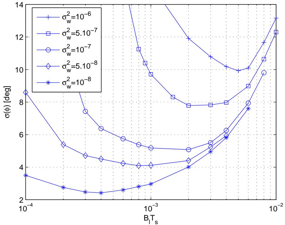
FIG. 5.2 – Performances de la boucle de phase porteuse en présence du bruit de phase de Wiener.
