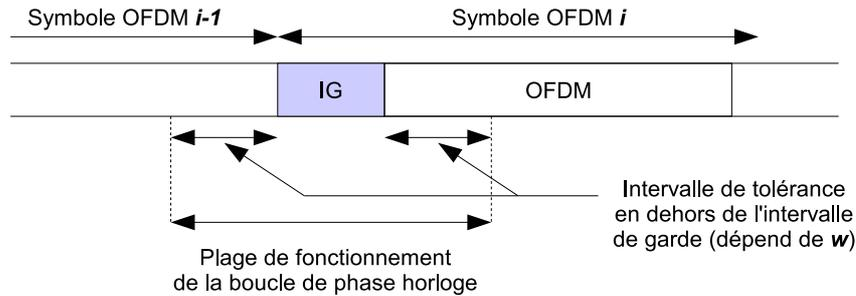
FIG. 3.22 – Plage de fonctionnement de la boucle de phase horloge.
