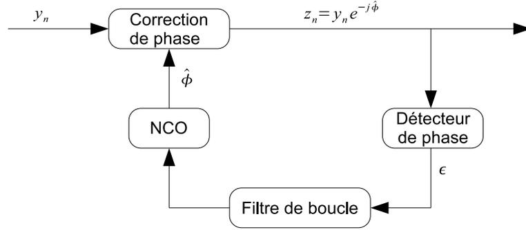
FIG. 2.10 – Principe d’une boucle de récupération de phase.
