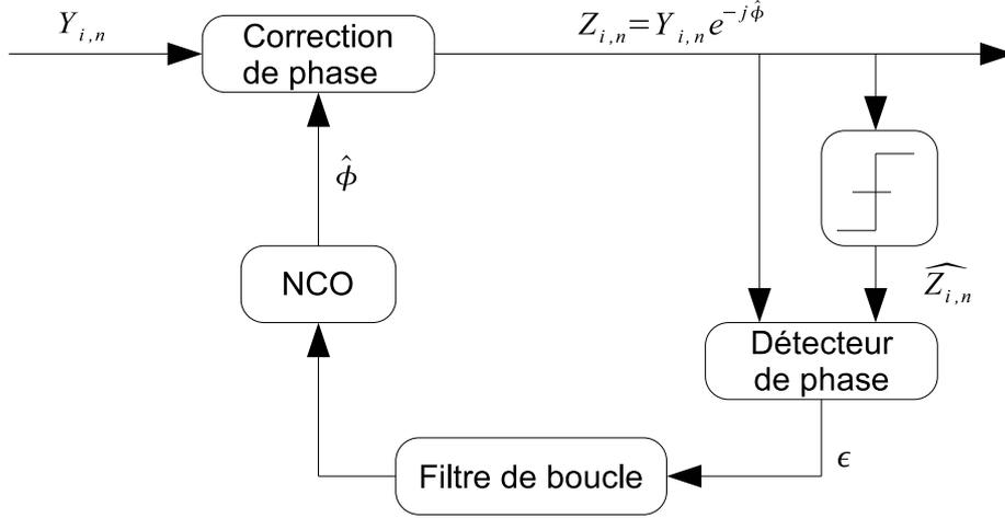
FIG. 4.1 – Schéma synoptique de la boucle de phase porteuse.
