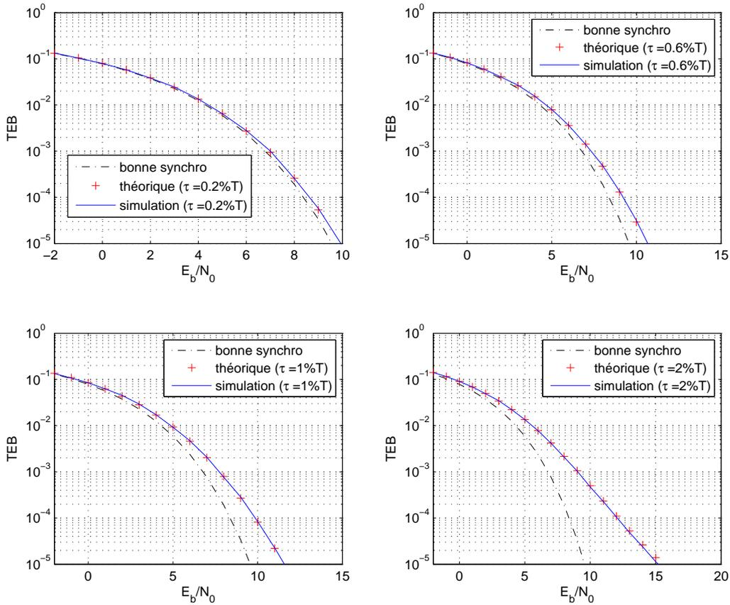
FIG. 2.3 – TEB théoriques et simulés, modulation QPSK.
