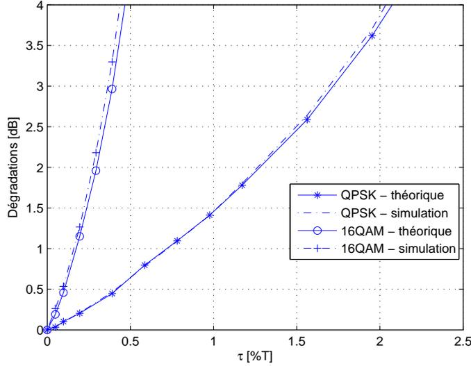
FIG. 2.5 – Dégradations des performances système à  $\text{TEB}=10^{-4}$ .
