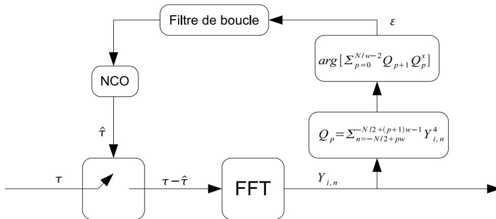
FIG. D.1 – Schéma de la boucle de phase horloge.
