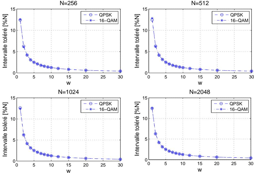
FIG. 3.13 – Plage d'erreur tolérée par le détecteur de la boucle de phase horloge, en dehors de l'intervalle de garde.
