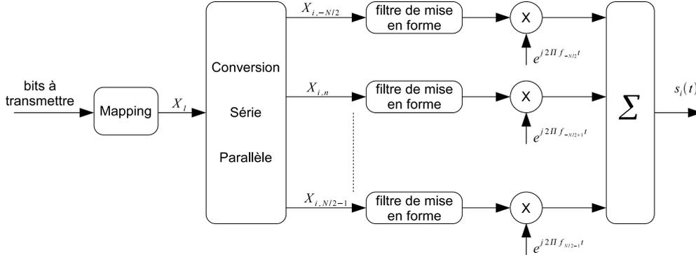
FIG. 1.8 – Schéma de principe d'un modulateur OFDM.
