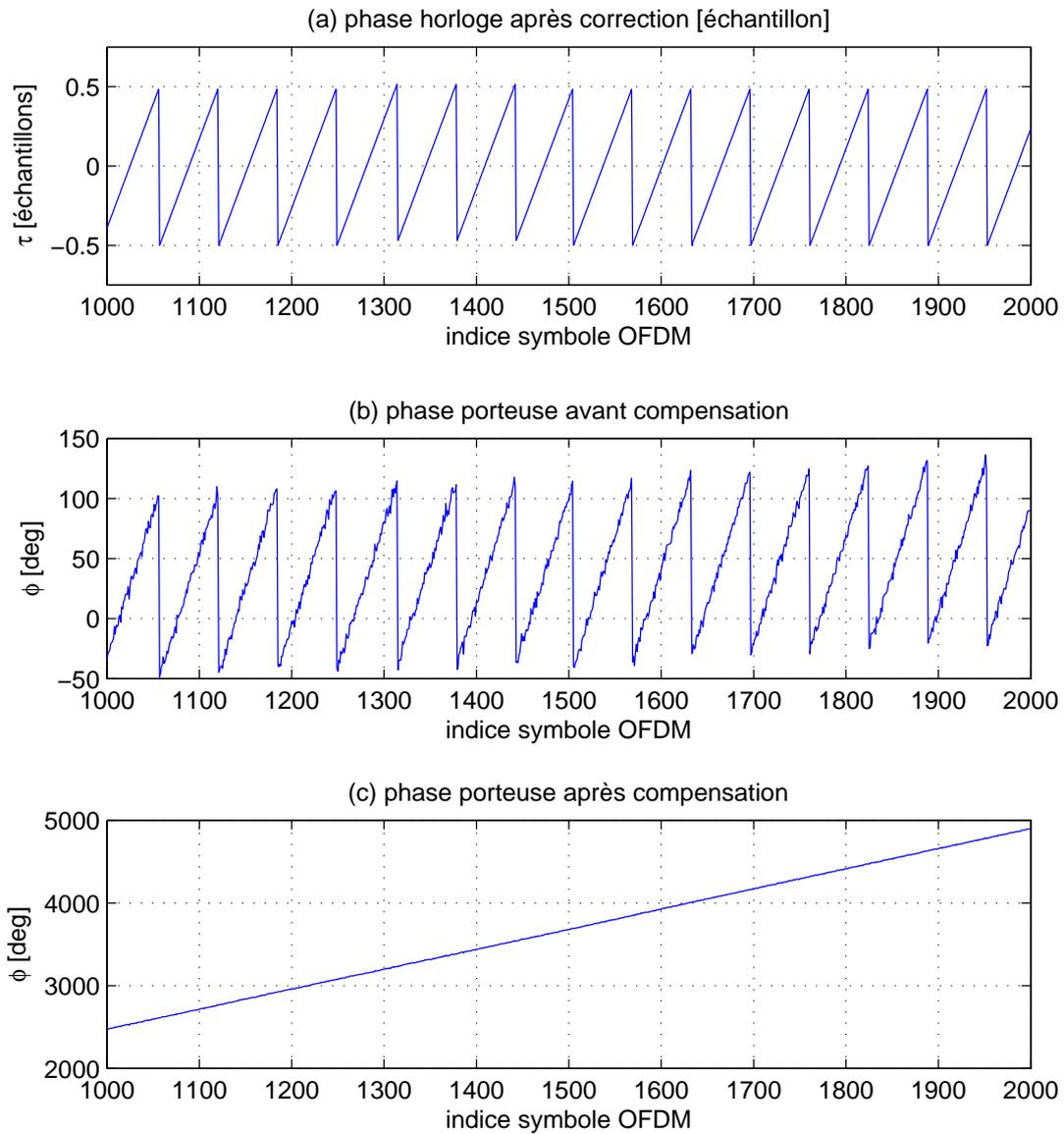
FIG. 4.5 – Phase porteuse avant et après compensation, porteuse numéro -108.
