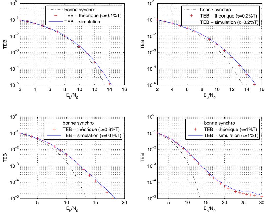
FIG. 2.4 – TEB théoriques et simulés, modulation 16QAM.
