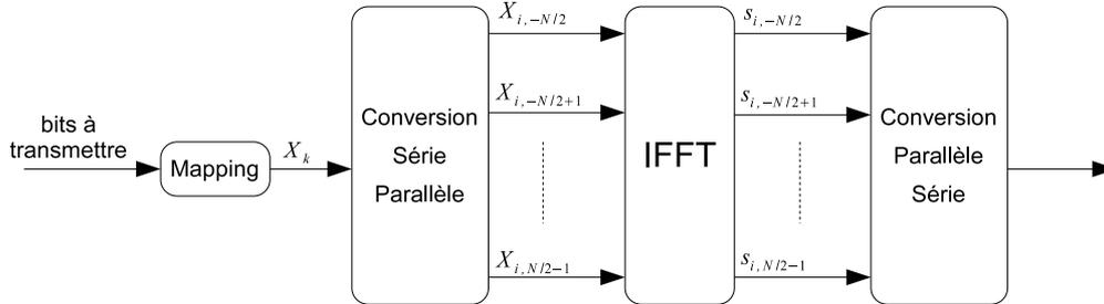
FIG. 1.11 – Schéma de principe du modulateur OFDM numérique.
