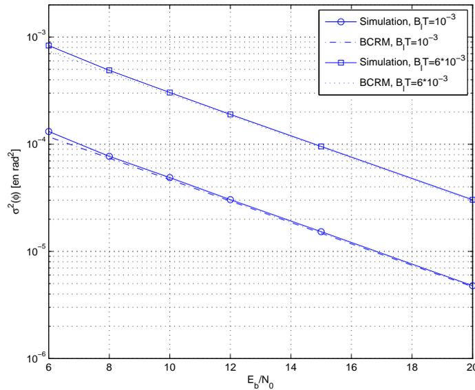
FIG. 4.9 – Performances de la boucle de phase porteuse en fonction de  $E_b/N_0$ , modulation QPSK.
