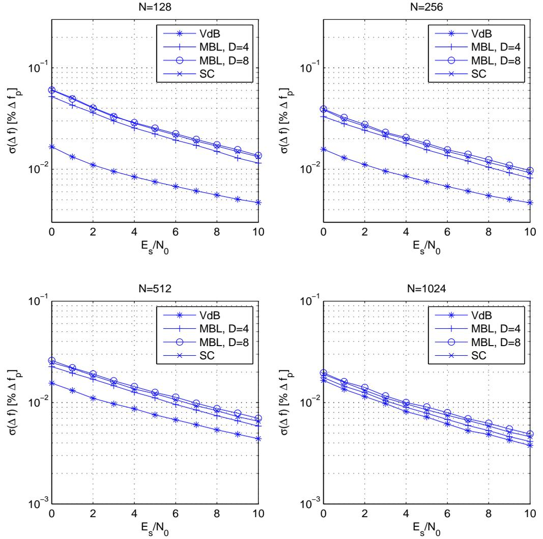
FIG. 3.27 – Performances des estimateurs de fréquence porteuse à efficacité spectrale équivalente,  $\beta = 1,2 \cdot 10^{-4}$ .
