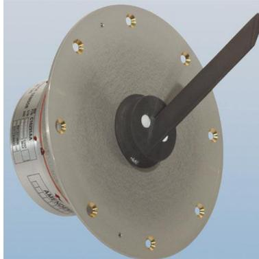
FIGURE 1.10 – Sonde de dérapage, design A380.
