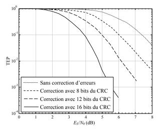
FIGURE 2 – TEP après correction. Comparaison des performances des correcteurs utilisant 0, 8, 12 et 16 bits du CRC.
