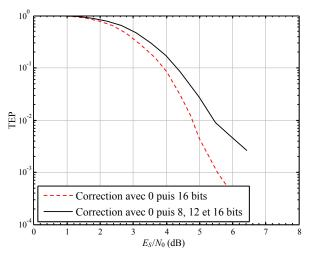
FIGURE 3 – TEP après correction. Le récepteur proposé est comparé avec celui présenté dans [6].
