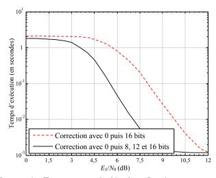
FIGURE 4 – Temps moyen de décodage. Le récepteur proposé est comparé avec celui présenté dans [6].
