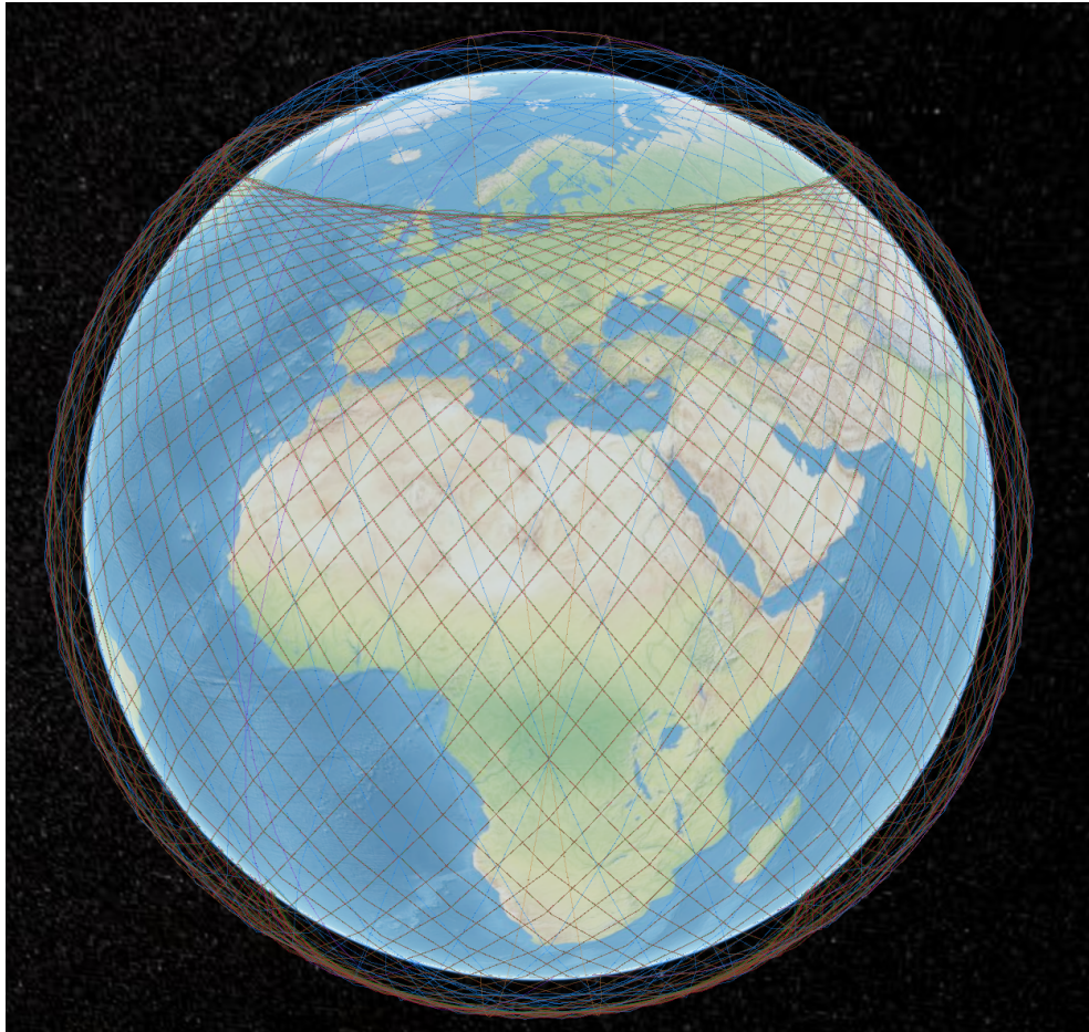
FIGURE 2.2 : Le projet Starlink Gen 1, en grande partie déployé, est composé de 5 couches situées entre 540 et 570km d'altitude. Les couches à haute inclinaison assurent la couverture des pôles, tandis que les couches à inclinaison réduite, plus dense à latitude plus faible, assurent une meilleure qualité de service aux utilisateurs. Image générée avec CesiumJS
