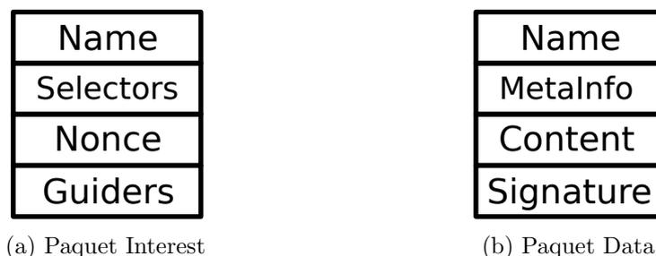
FIGURE 1.4 Format des paquets dans NDN
