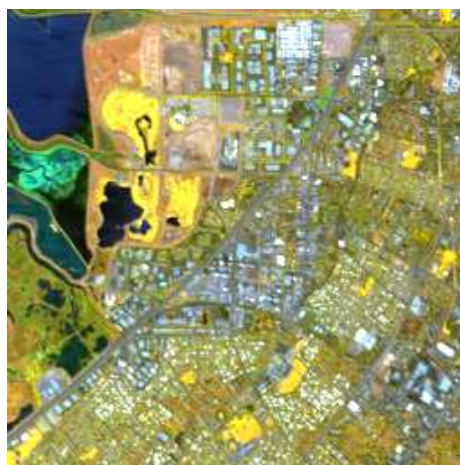
Fig. 2.3 Moffett3 plus contrastée : composition colorée à partir des bandes 90 (1211.33 nm), 40 (731.21 nm) et 20 (557.07 nm). Cette zone contient des bâtiments, des routes.
