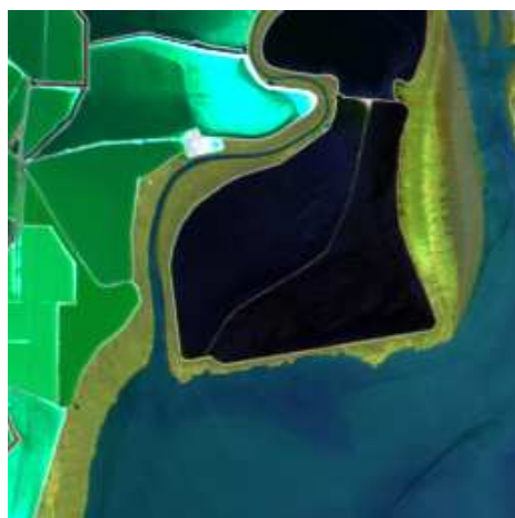
Fig. 2.2 Moffett4 avec des zones uniformes : composition colorée à partir des bandes 90 (1211.33 nm), 40 (731.21 nm) et 20 (557.07 nm). Cette zone contient des marais salants et de la mer.
