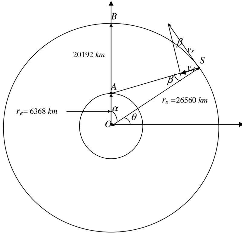
**Fig. C-1: Doppler Shift due to satellite motion**
