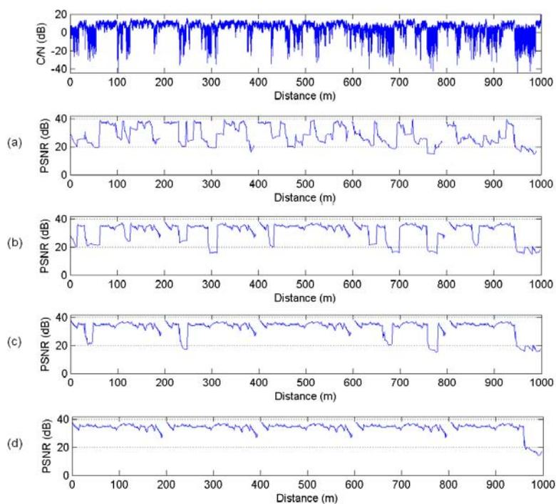
FIGURE 4.6 – PSNR pour  $v = 15$  m/s et pour (a)  $T_{\text{block}} = 0$  s (sans FEC, mais avec un débit vidéo de 250 kbps), (b)  $T_{\text{block}} = 1$  s, (c)  $T_{\text{block}} = 2$  s and (d)  $T_{\text{block}} = 3$  s,
