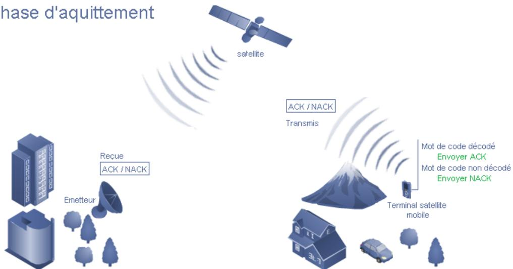
FIGURE 3.9 – Procédures mises en œuvre par l'émetteur et le récepteur
